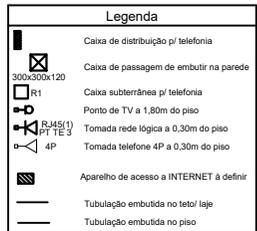
NOTAS: 1) A Ligação dos pontos de TV deverão ser feitas pelo telhado. Cada ponto deverá ter eletroduto embutido na parede com suas ligações feitas sobre a laje.
